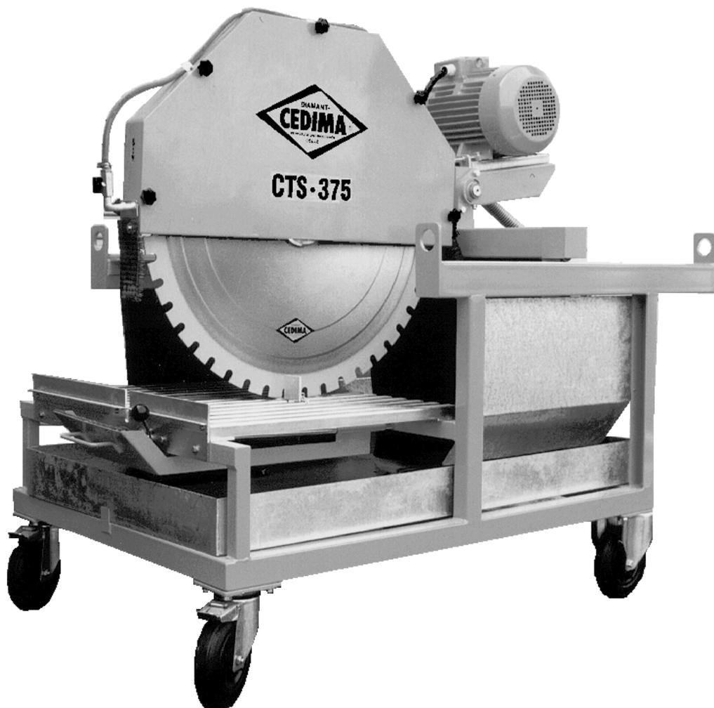
CEDIMA® Tischsagen zeichnen sich durch einfache Handhabung sowie äußerste Präzision aus. Sie sind leicht zu transportieren und können somit immer dort aufgestellt werden, wo das Material verarbeitet werden soll. Antriebseinheit und Schneidwellendrehzahl wurden so ausgelegt, daß optimale Bedingungen für das Schneiden mit CEDIMA® Diamant - Trennscheiben herrschen.
