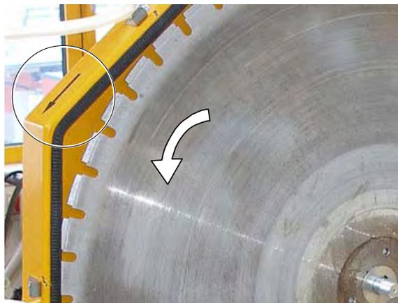
Auf der Diamant-Trennscheibe befindet sich ein Schneid-, Drehrichtungs-Pfeil. Sollte dieser Pfeil nicht sichtbar sein, ist die Schneidrichtung der Diamant-Trennscheibe folgendermaßen bestimmbar:
