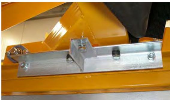
Schneidwagen-Unterseite, Einstellwinkelan der Handradseite
