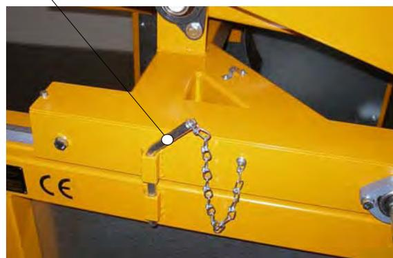
*Sicherungsbolzen in Halterung, Schneidwagen beweglich*
