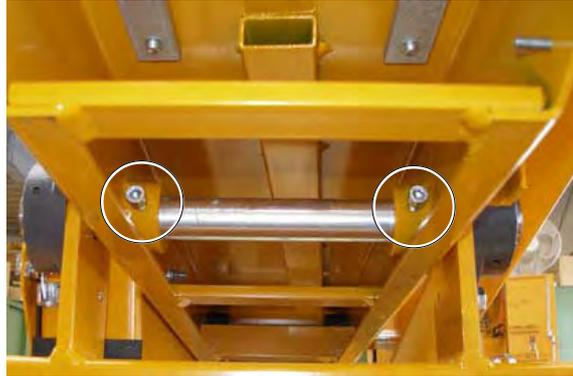
Einstellschrauben am Pendelschneidarm-Schwenklager
