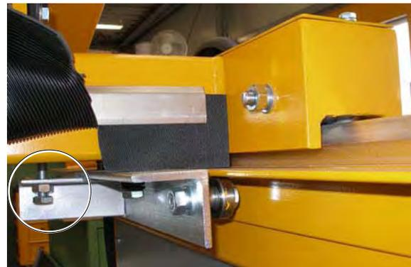
Schneidwagen-Unterseite, Einstellschraube mit Kontermutter an der Handradseite, Tischsägen-Rückseite
