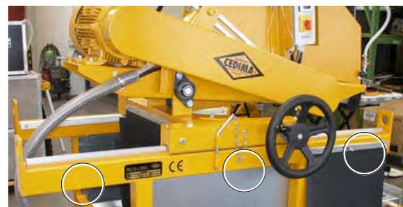
Innensechskant-Schrauben der Schneidwagen-Führungsschiene
