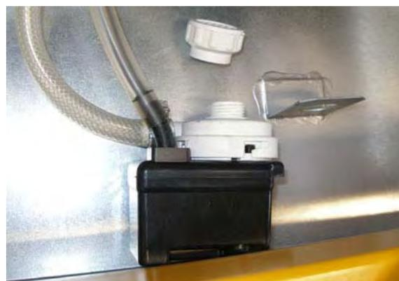
8. Die Wasserwanne soweit füllen, daß die Wasserpumpe bedeckt ist! Die Tischsäge und damit die Wasserpumpe (unter Beachtung der Sicherheitshinweise) EIN-schalten! Den Wasserabsperrhahn am Blattschutz öffnen und den Wasserdurchfluß zur Trennscheibe kontrollieren!
