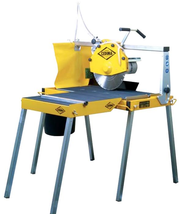
Für Gehrungsschnitte wird der gesamte Oberbau der Säge geschwenkt. Der Gehrungswinkel kann dabei stufenlos zwischen 0° und 45° eingestellt werden. Es ist jedoch zu beachten, dass die erreichbare Schnitttiefe mit zunehmender Schrägstellung abnimmt.
