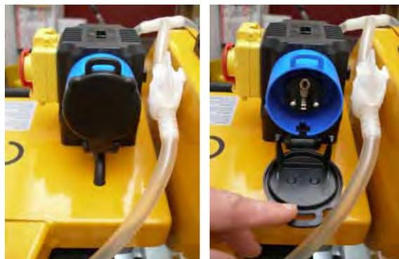
**Bild 4.37,** 230 Volt Netzanschluß-Stecker, links Deckel geschlossen, rechts geöffnet
