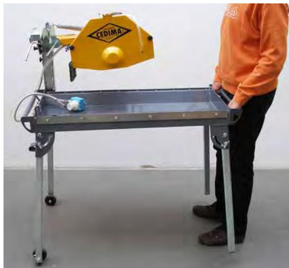
**Bild 5.5,** CTS•57 G, Transport mit den an den Standfüßen montierten Transportrollen, Rolltisch demontiert
