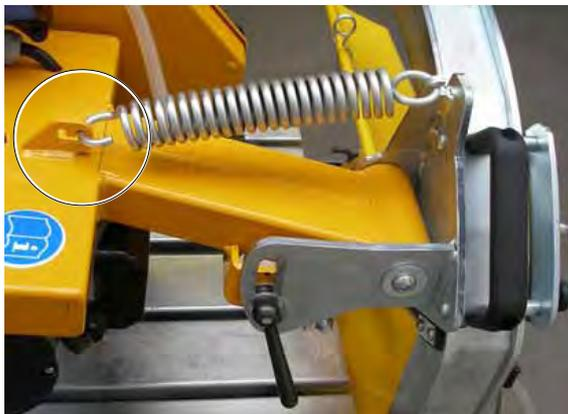
Bild 4.28, Pendelschneidarm Haltefeder
