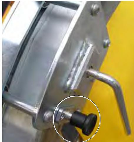
**Bild 4.31**, Klemmhebel oben, Rastbolzen am Pendelschneidarm-Schlitten gezogen (außer Funktion)
