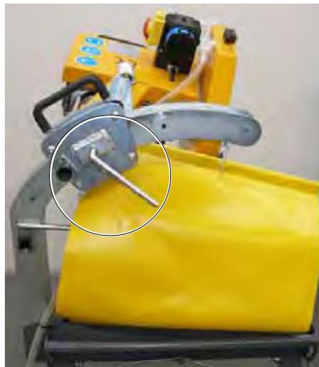
**Bild 4.35,** Pendelschneidarm-Schlitten in rastbaren Gehrungswinkel 15° geschwenkt
