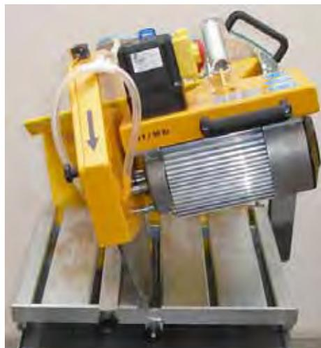
**Bild 4.36,** Pendelschneidarm-Schlitten in rastbaren Gehrungswinkel 15° geschwenkt
