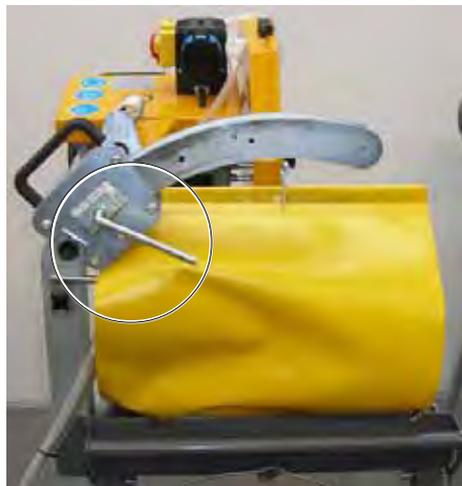
**Bild 4.33,** Pendelschneidarm-Schlitten in rastbaren Gehrungswinkel 0° geschwenkt
