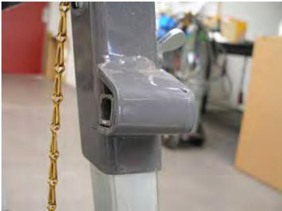
**Bild 5.6,** CTS•57 G, Transportrollenaufnahme am Tischsägenrahmen, Transportrolle demontriert
