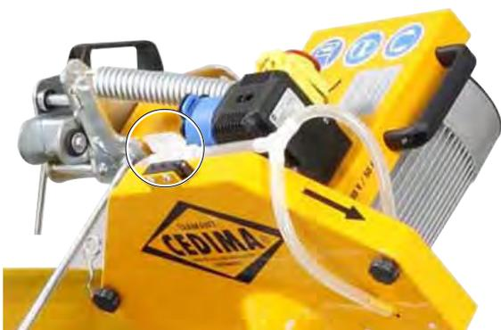
Bild 4.15, Wasser-(Regel-) Ventil und beidseitige Wasserzuführung zur Trennscheibe
