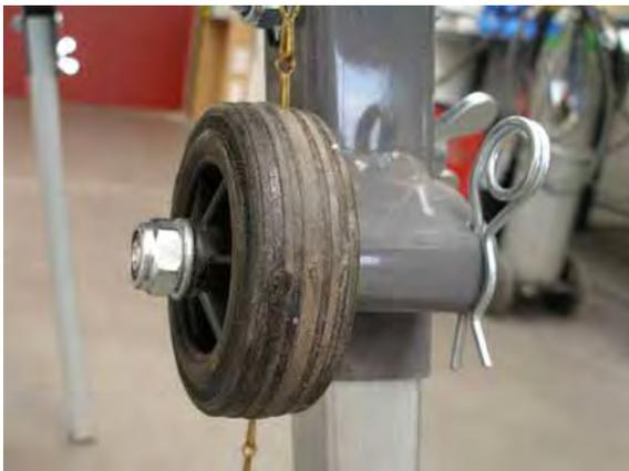
**Bild 5.7,** CTS•57 G, am Tischsägenrahmen montierte Transportrolle
