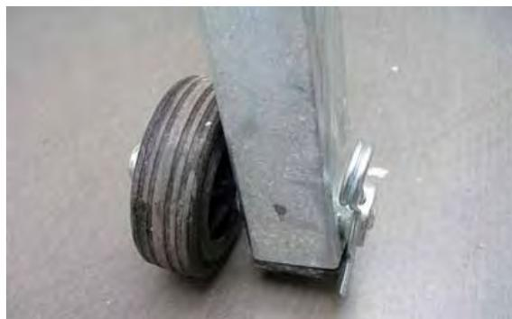
**Bild 5.4,** CTS•57 G, am Standfuß montierte Transportrolle
