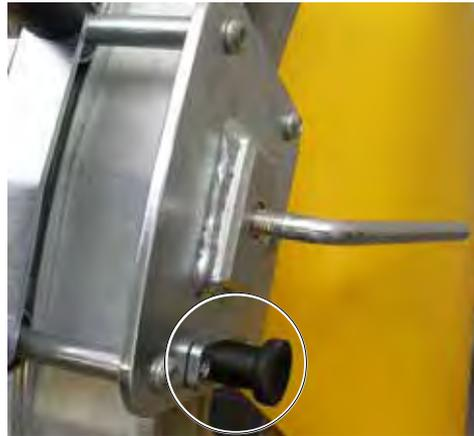
**Bild 4.30**, Klemmhebel oben, Rastbolzen am Pendelschneidarm-Schlitten eingerastet
