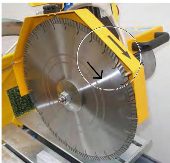
**Bild 4.24**, Diamant-Trennscheibe montiert, Schneidwellen- und Trennscheiben-Schned-richtung
