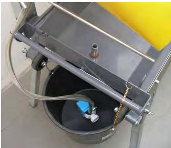
Bild 4.14, Wasserpumpe in Wassereimer, Überlaufrohr in Wasserwanne
