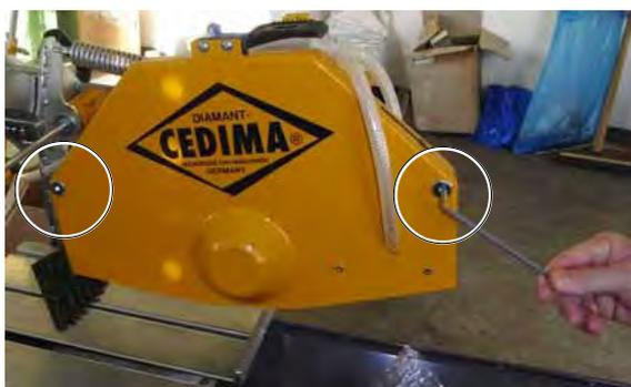
**Bild 4.17**, 2 Rundmuttern am Blattschutz-Deckel
