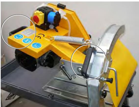
**Bild 4.29**, Pendelschneidarm-Schlitten mit den beiden Griffen in den Gehrungswinkel schwenken
