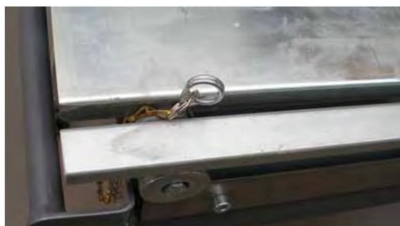
Bild 4.1, Rolltisch mit entsprechender Sicherung arretiert
