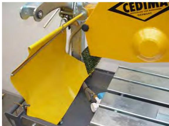
**Bild 4.12,** Spritzschutz montiert
