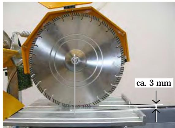
**Bild 4.27,** Pendelschneidarm (Trennscheibe auf volle Schnittiefe eingestellt
