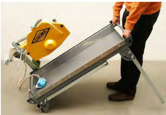
**Bild 5.8,** CTS•57 G, Transport mit den am Tischsägenrahmen montierten Transportrollen, Standfußpaar eingeklappt, Rolltisch demontiert
