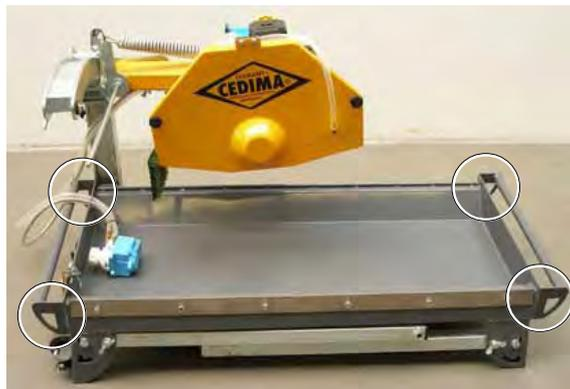
**Bild 5.9,** CTS•57 G, Ösen an den Griffrohren, Standfüße eingeklappt, Rolltisch demontiert
