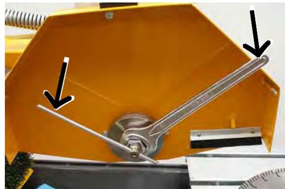
**Bild 4.19**, Schneidwellen-Mutter lösen
