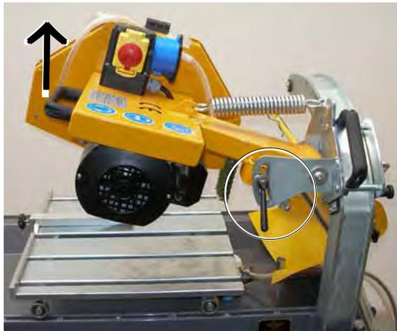
**Bild 4.16**, Pendelschneidarm ausgehoben und mit Klemmhebel arretiert
