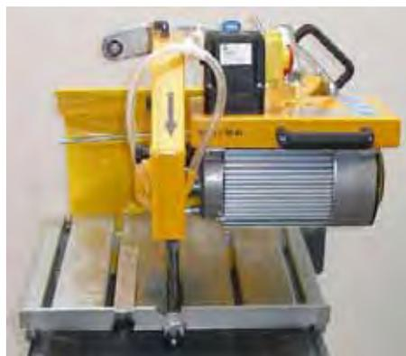
**Bild 4.34,** Pendelschneidarm-Schlitten in rastbaren Gehrungswinkel 0° geschwenkt
