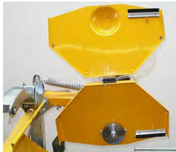
**Bild 4.18**, Blattschutz-Deckel aufgeklappt
