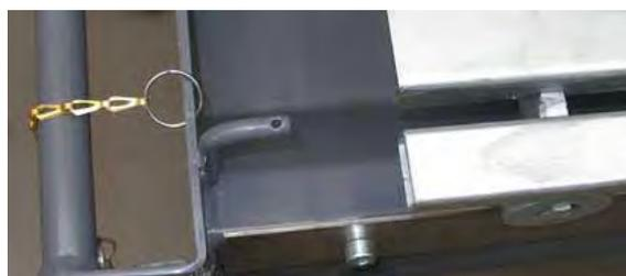
Bild 4.2, Rolltisch-Sicherung gelöst
