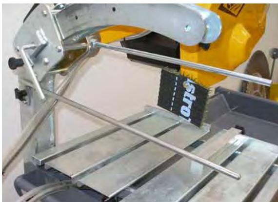
**Bild 4.11,** Spritzschutzhaltestange montiert
