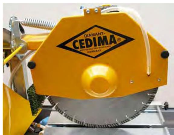
**Bild 4.25**, Trennscheibe montiert, Blattschutzdeckel geschlossen
