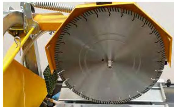
**Bild 4.22**, Diamant-Trennscheibe auf Schneidwelle gesetzt
