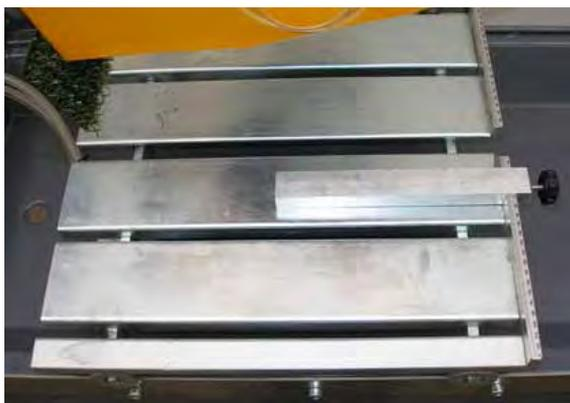
**Bild 4.10,** Seitenanschlag auf Rolltisch geklemmt
