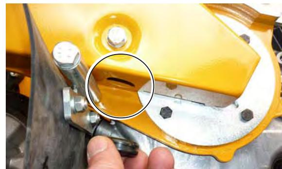
CF•1010 B, links, hinten (Motor) Keilrippenriemen-Wartungsöffnung unten am Keilrippenriemenschutz (Gummistopfen entfernt)
