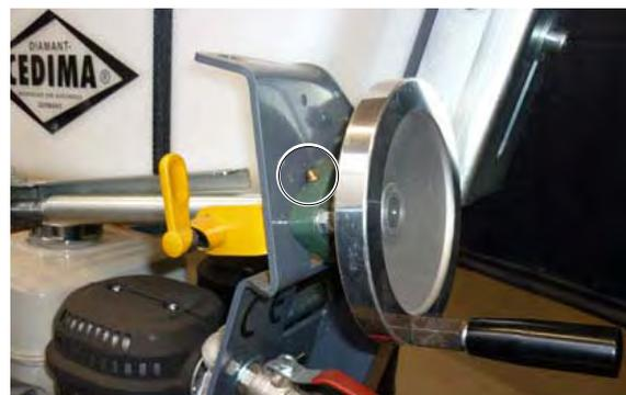
Druckschmierkopf am Handrad der Schnittiefeinstellung
