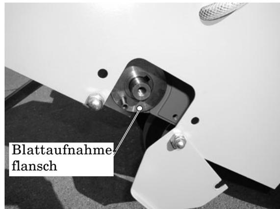
Schutzblech am Blattschutz über der Schneidwelle geöffnet (Schneidwellen-Schraube, Druckflansch und Trennscheibe demontiert)
