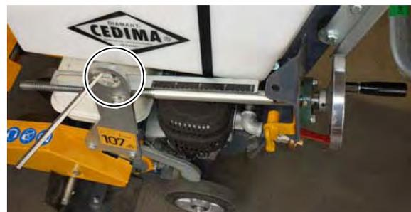
Innensechskantschraube auf der Schnittiefenanzeige lösen
