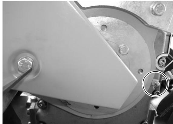
Druckschmierkopf der Schneidwellenschwinge (links) am Motor
