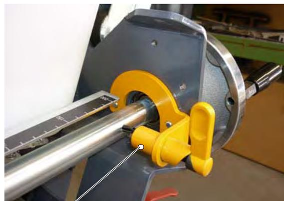
Handrad (Kurbel) zur Schnittiefeneinstellung (Sicherung eingerastet)
