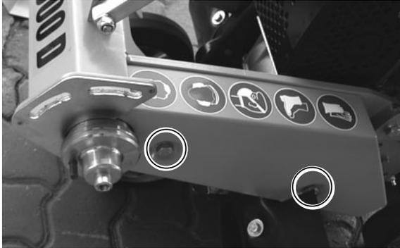
Schrauben am Keilrippenriemenschutz
