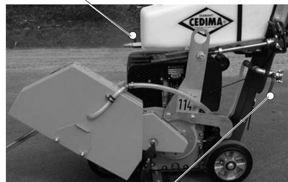
Druckwasser-Absperrhahn mit Geka-Anschluß
