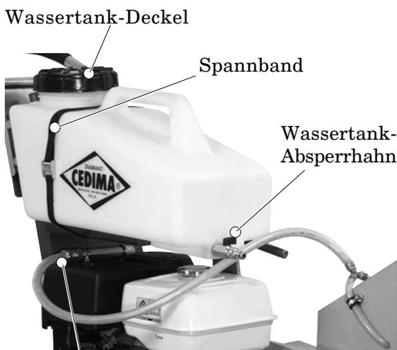
Verbindungsschlauch mit Gardena-Anschluß
