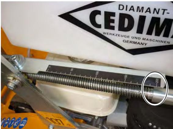
Schneidwelle vollständig abgesenkt (200)
