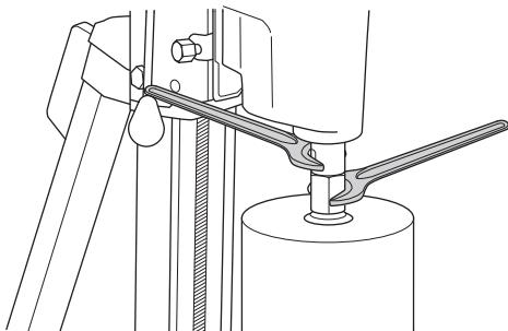
Prima di avviare la macchina, verificare con cura che la punta sia fissata correttamente.
