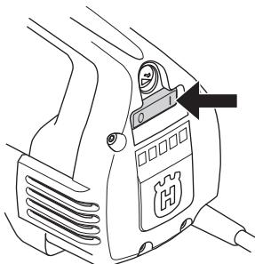
L'interrupteur est utilisé pour démarrer et arrêter la machine.
