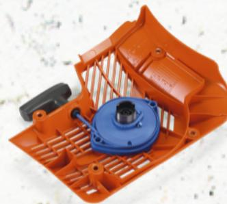
Unser gekapselter Startmechanismus, bei dem Rückholfeder und Seilscheibe durch ein Gehäuse geschützt sind, ist praktisch wartungsfrei. Mit einem haltbaren Starterseil versehen.
