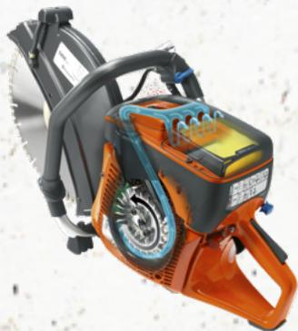
Unser zweistufiges Filtersystem mit Fliehkraft-Luftreinigung und nur einem Papierfilter erhöht die Lebensdauer der Maschine und ermöglicht längere Wartungsintervalle.
