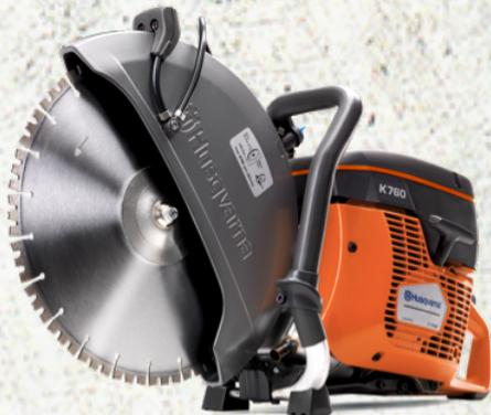
Der neue Zylinder erhöht die Trennschleifer-Leistung in mehrfacher Hinsicht. Die effizientere Verbrennung und die zusätzlichen Kühlrippen reduzieren die Abgasemissionen um 15 %. Außerdem entsteht eine optimale Betriebstemperatur, sodass die Maschine weniger anfällig für Wetter- und Kraftstoffschwankungen ist.
