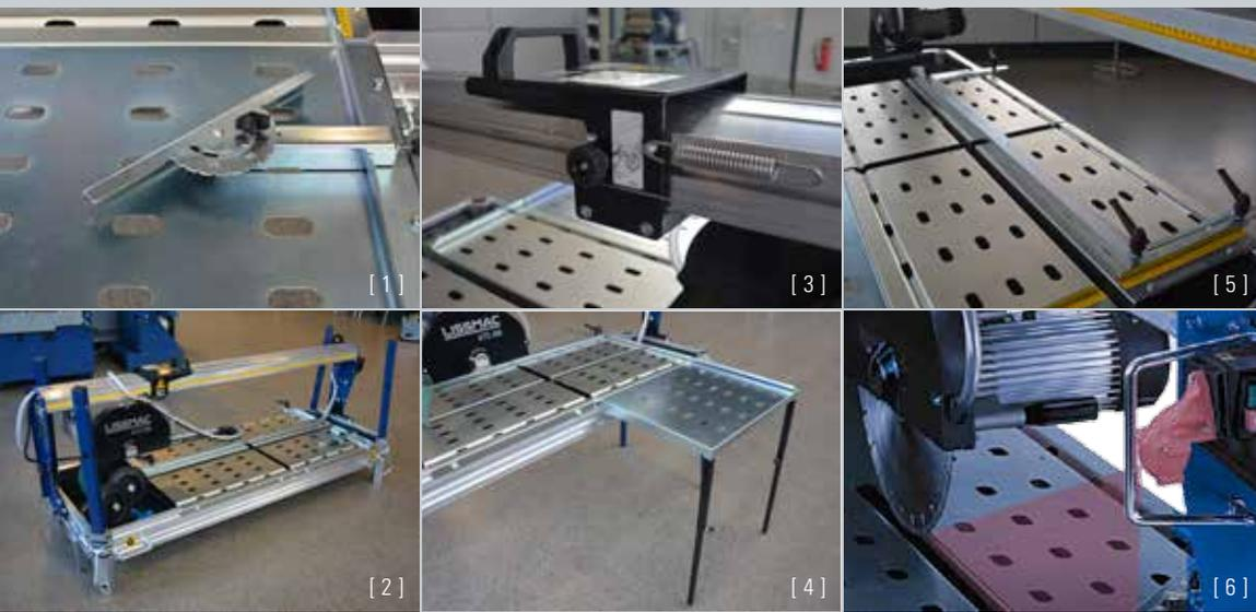
Die konsequente Verwendung von Aluminium, Edelstahl und Kunststoff macht die ATS Steintrennsägen ausgesprochen leicht, robust und nahezu rostfrei. Geeignet sowohl für gerade Schnitte, als auch Gehrungsschnitte für Schrägschnitte von Ziegel, Steinen, Granit, Marmor und Naturstein-Platten bis 45°.
