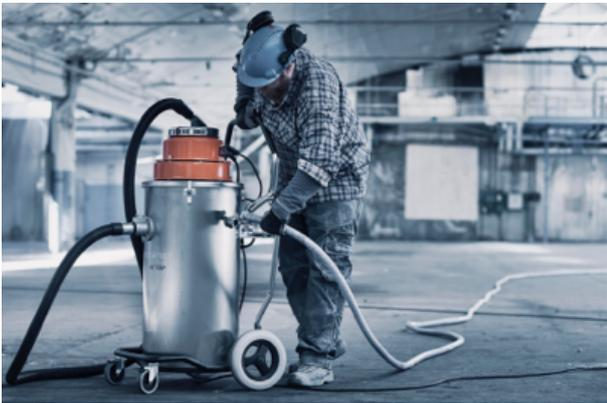
Die kraftvollen Saugpumpen sind in der Lage, Schlamm 9 m vertikal oder 200 m horizontal zu pumpen.
